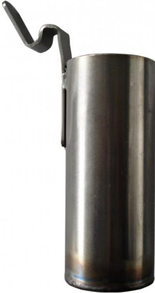
Portaprovette B in acciaio inox, per una bottiglia Babcock (massimo 24 per Rotore G/B/S).
